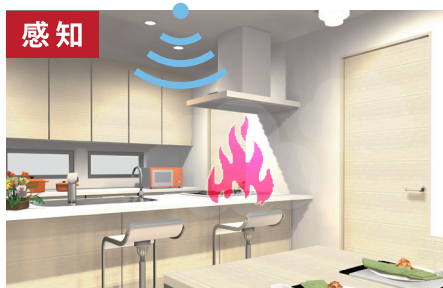
ケスジャンが火災の熱を 72°Cで感知
